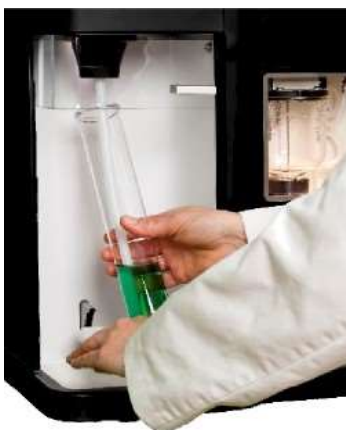
การใส่หลอดในเครื่อง KjelROC
